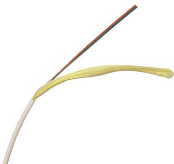
Cavo in fibra ottica monomodale da interno con 8 fibre 9/125 (G.657 Categoria A). Classificazione CPR Cca, s1a, d0, a1.
